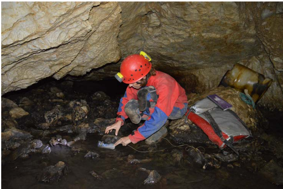
Slika 21: Izbira mesta za postavitev in obtežitev vodne pasti (foto: F. Drole)
